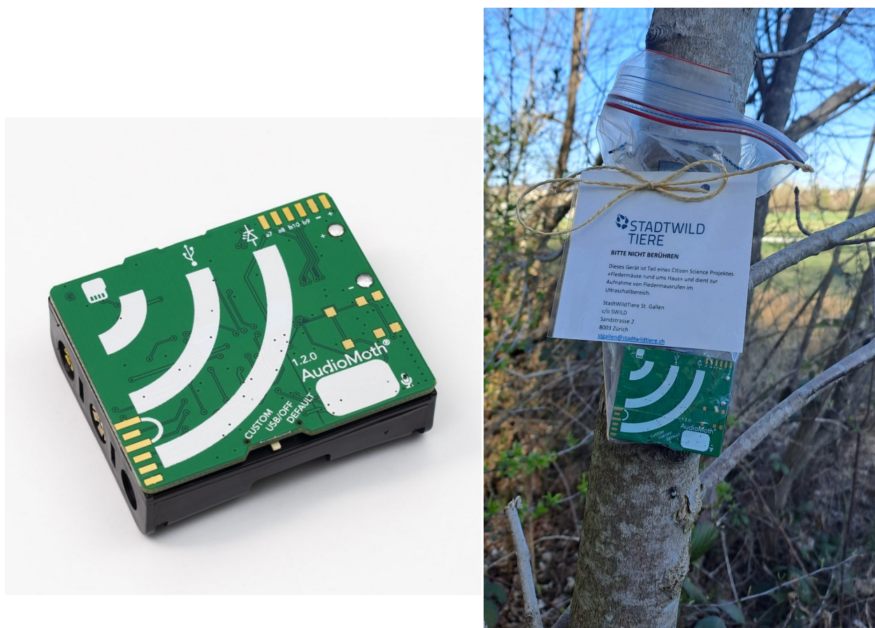
Abb. 7: AudioMoth der Firma Open Acoustics Devices (links) an einem Test-Aufnahmestandort (rechts). Der Plastikbeutel bewährte sich als Feuchtigkeitsschutz und behinderte die Aufnahmequalität kaum.
